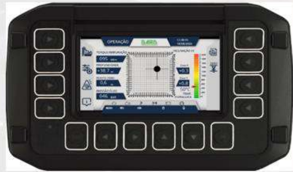
MONITORAMENTO DA ESTACA
