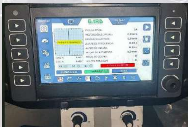
Tela de operação / monitoramento da cravação
